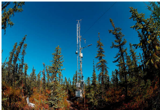
米国アラスカ州フェアバンクス市の永久凍土上のクロトウヒ林に設置された、森林のCO 2 吸収を評価するための気象観測タワー。
